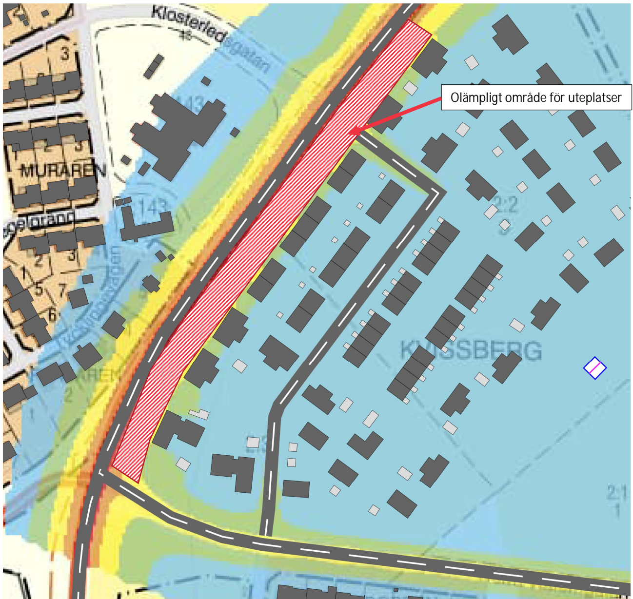
FIGUR 2. ILLUSTRATION ÖVER OMRÅDE DÄR UTEPLATSER INTE KAN PLACERAS UTAN BULLERSKYDDSÅTGÄRDER.
